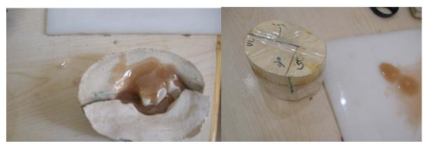
Fig 6. Colour matching and silicone pour
